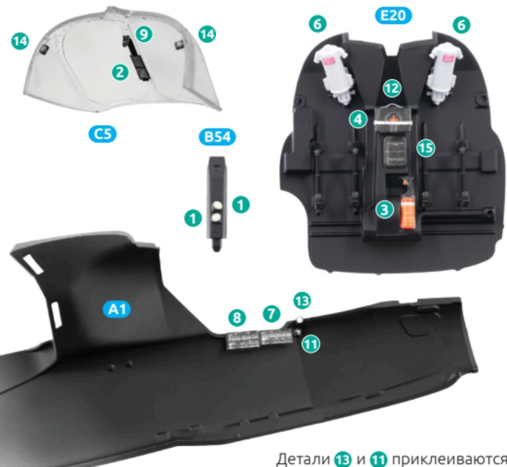
Детали **13** и **11** приклеиваются на обе половины фюзеляжа
